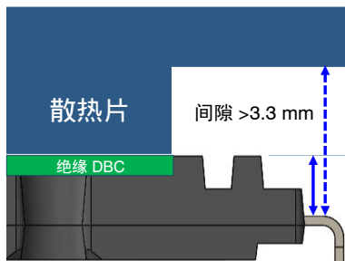
图 17. 可实现的间隙图示
