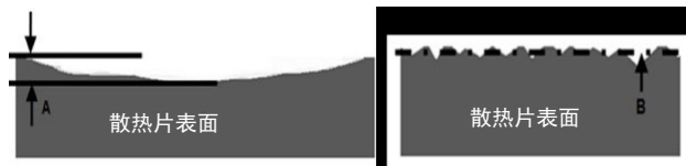
图 20. 散热片的平整度 (a) 和粗糙度 (b)
