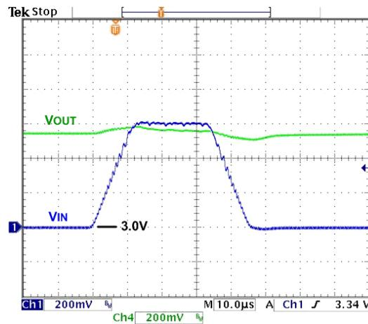
图 19. 线路瞬态, 3.0–3.6  $V_{IN}$ , 10  $\mu\text{s}$  边沿, 1.0 A 负载
