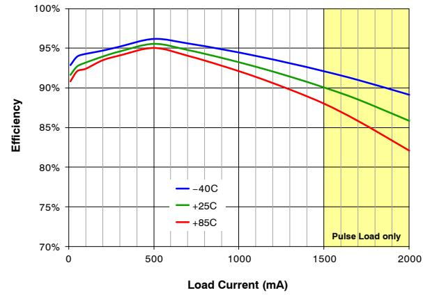
图 8. 效率与负载电流和温度的关系
