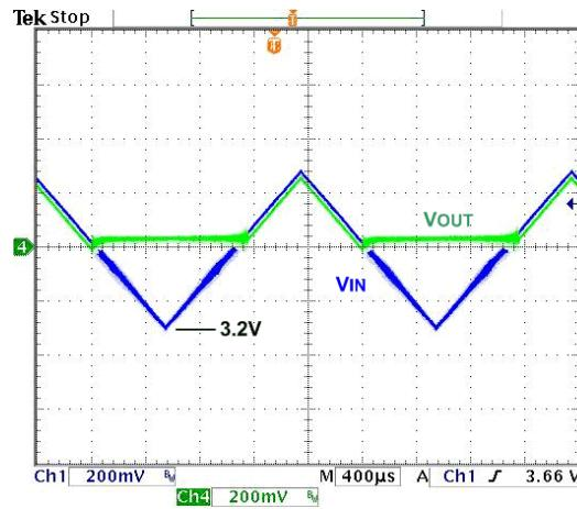
图 21. 进入 / 退出旁路, 缓慢  $V_{IN}$  斜坡, 1 ms 边沿, 500 mA 负载, 3.2–3.8  $V_{IN}$
