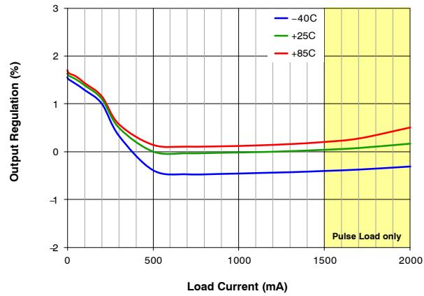
图 10. 输出调节与负载电流和温度的关系
