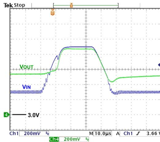
图 20. 线路瞬态, 3.3–3.9  $V_{IN}$ , 10  $\mu\text{s}$  边沿, 1.0 A 负载
