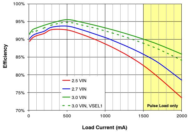
图 7. 效率与负载电流和输入电压的关系
