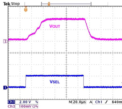
图 22.  $V_{SEL}$  步进,  $V_{IN} = 3.0 \text{ V}$ , 500 mA 负载
