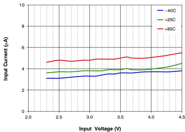
图 12. 静态电流与输入电压和温度的关系
