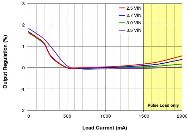
图 9. 输出调节与负载电流和输入电压的关系
