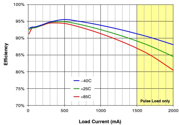
图 6. 效率 vs 负载电流和温度的关系
