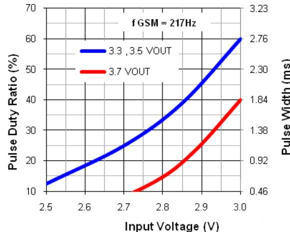
图 23. 用于 2 A GSM 脉冲的最小  $V_{IN}$ , 3.5 V $V_{OUT}$
