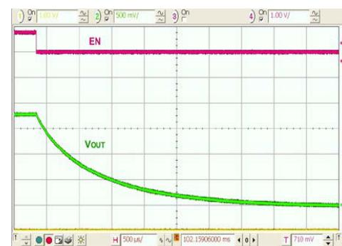
图 27. 关断, 无负载, 输出放电已启用
