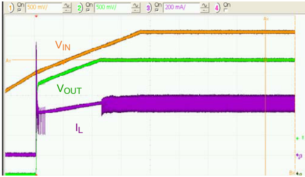
图 17. 500 mA 负载, 1 ms/div, 启动变化 V_{IN} = V_{EN}
