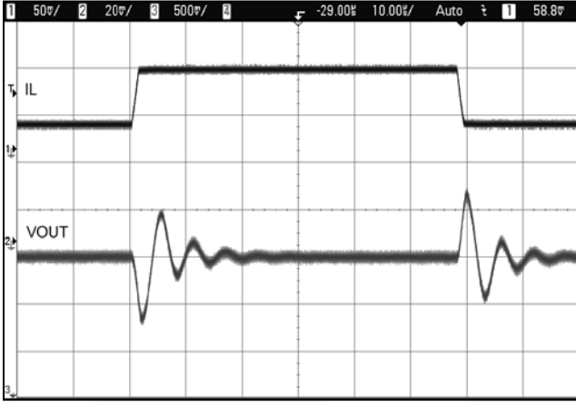
图 28. 高功率模式下的负载瞬态响应, 200 mA至800 mA, V_{OUT} = 2.5\text{ V}
