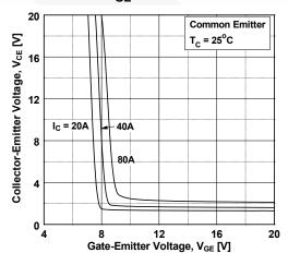
图 6. 饱和电压与 V<sub>GE</sub> 的关系
