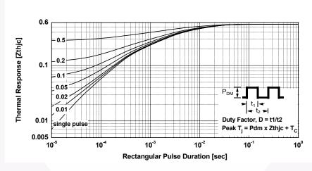
图 22. 二极管瞬态热阻抗
