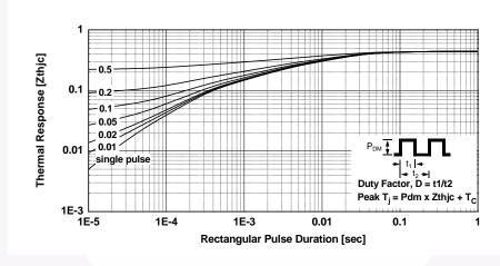
图 22. 二极管瞬态热阻抗
