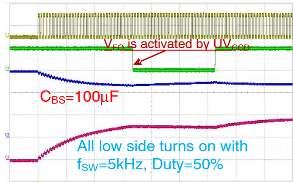
图 34. 根据自举电容和充电方法操作的初始充电 (参考条件: V_{CC} = 15\text{ V} / 300\text{ mA} , V_{CC} 电容 = 220\text{ }\mu\text{F} , 自举电容 = 100\text{ }\mu\text{F} , R_{BS} = 20\text{ }\Omega )
