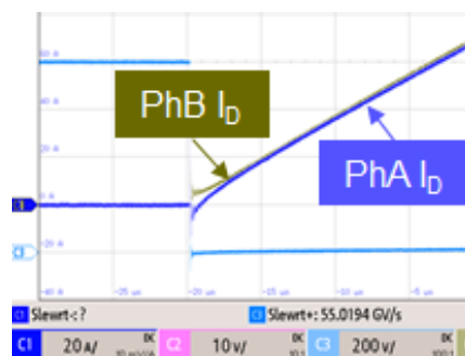
图 2. 阈值电压失配导致的动态电流失配
