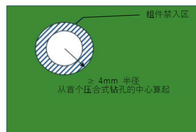
图 3. PCB 压合式孔的定义和每个压合式孔周围的组件禁入区
