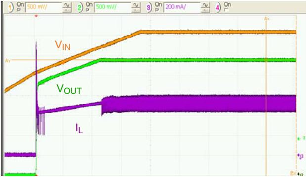
图 17. 500 mA 负载, 1 ms/div, 启动变化  $V_{IN} = V_{EN}$
