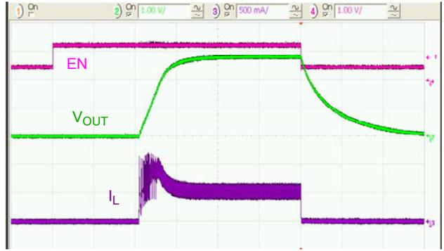
图 18. 500 mA 负载, 50 ms/div, 启动和关断  $V_{EN}$
