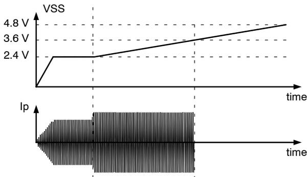
图 69. 软启动延迟关断
