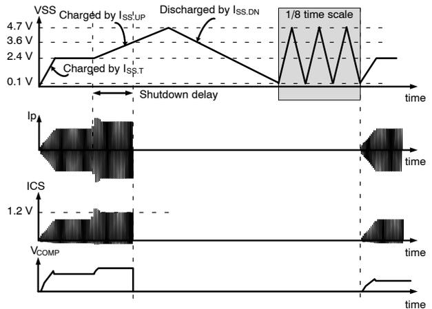
图 70. 触发保护后的自动重启
