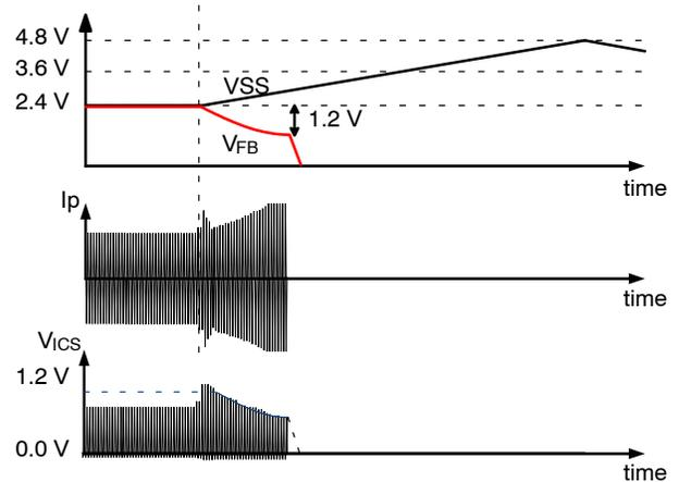
图 71. 输出短路保护
