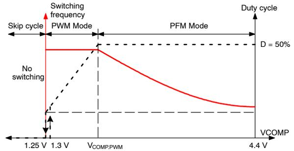
图 58. 随 COMP 电压变化的模式
