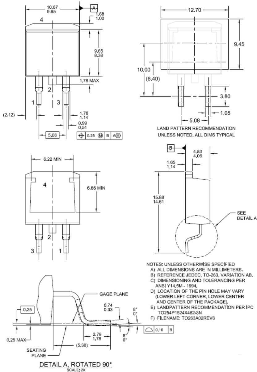
图 16. TO263 (D<sup>2</sup>PAK) 模塑, 2 引脚, 表面贴装
