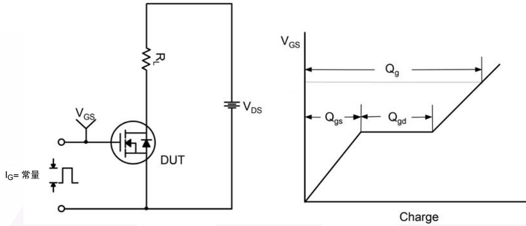
图 12. 栅极电荷测试电路与波形
