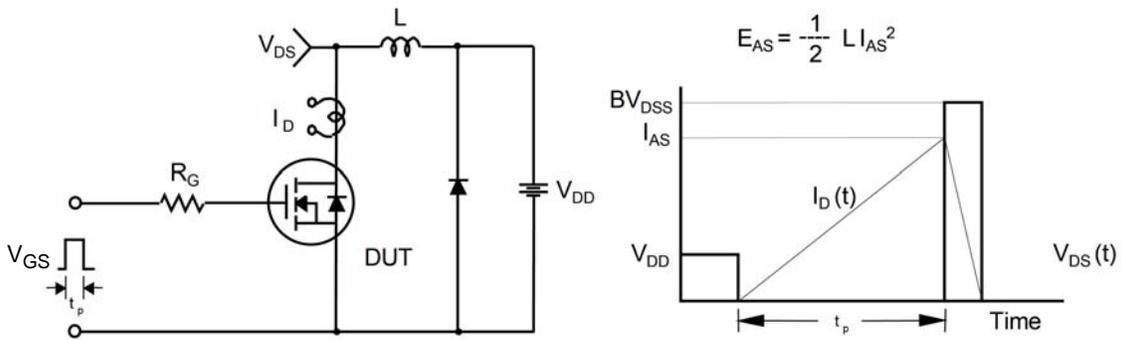
图 14. 非箝位感性开关测试电路与波形
