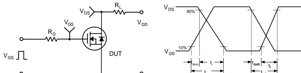
图 15. 阻性开关测试电路与波形
