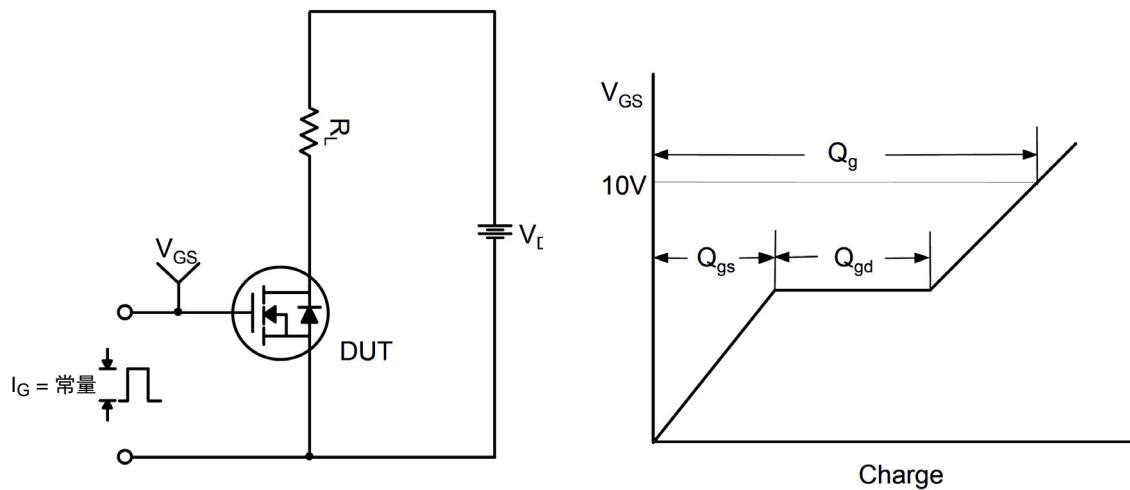
图 14. 栅极电荷测试电路与波形
