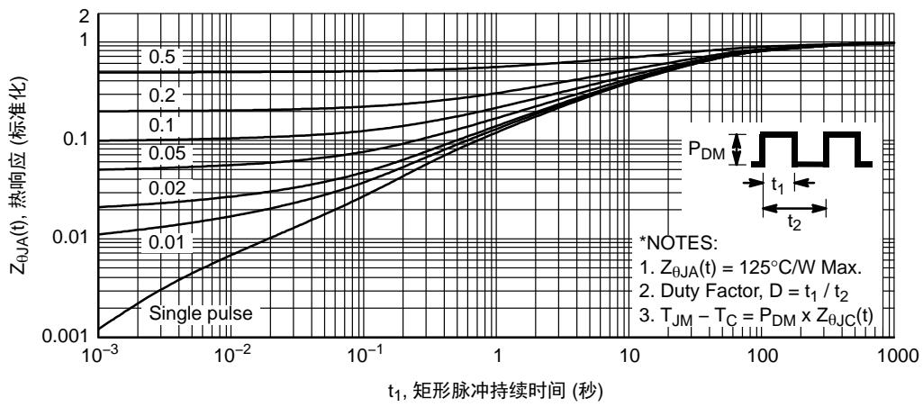
图 13. 瞬态热响应曲线
