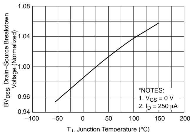
图 7. 击穿电压变化与温度
