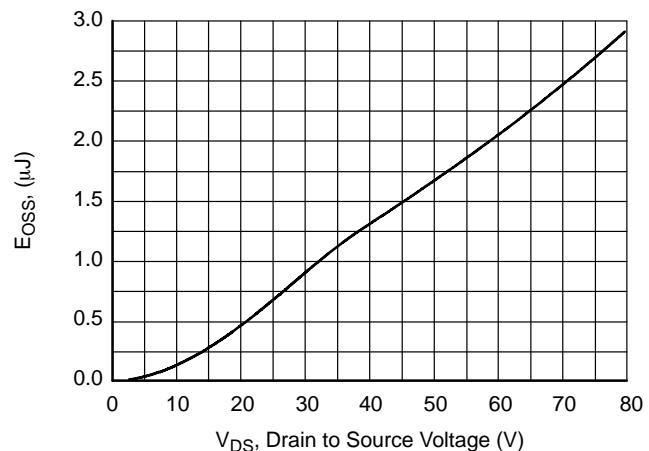
图 12. 输出电容 (Eoss) 与漏极-源极电压
