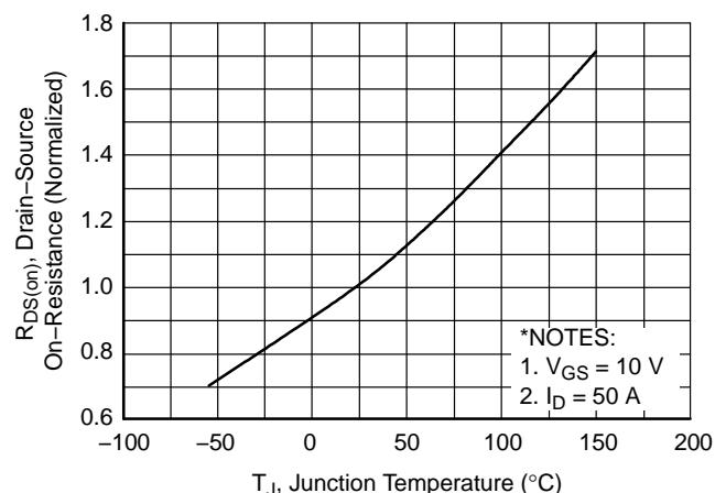
图 8. 导通电阻变化与温度
