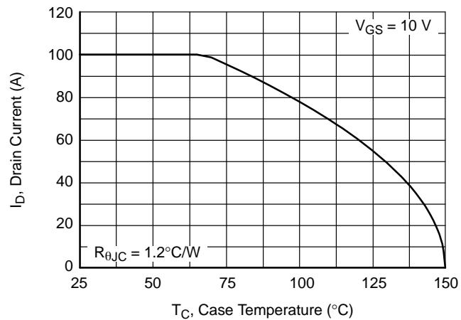
图 10. 最大漏极电流与外壳温
