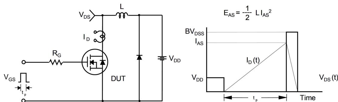
图 16. 非箱位电感开关测试电路与波形
