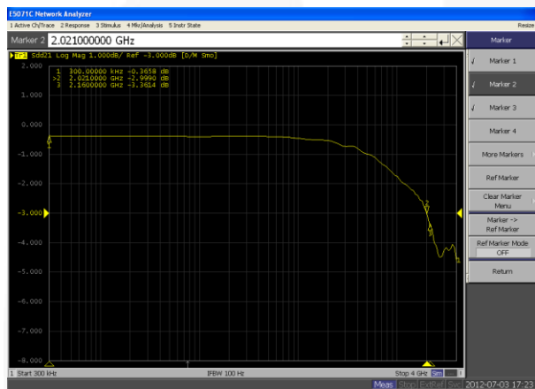
图 17. MHL 路径 SDD21 插入损耗曲线
