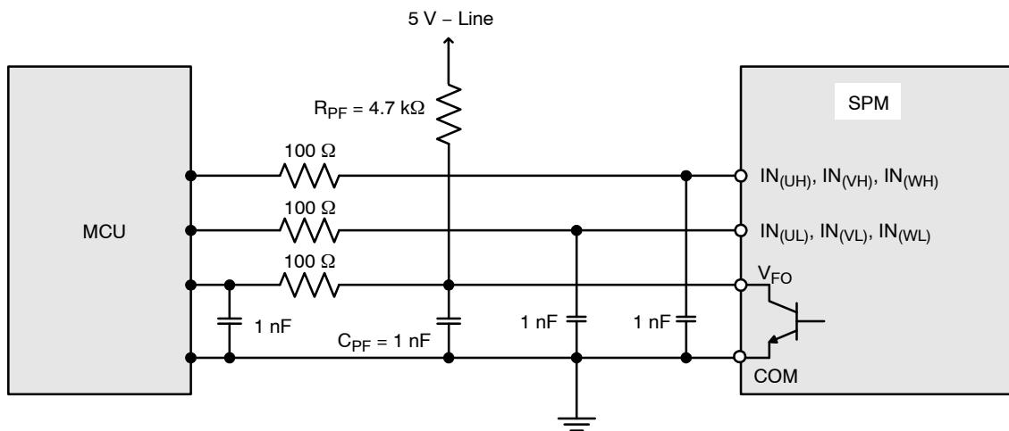
图 10. 推荐的 MCU I/O 接口电路
