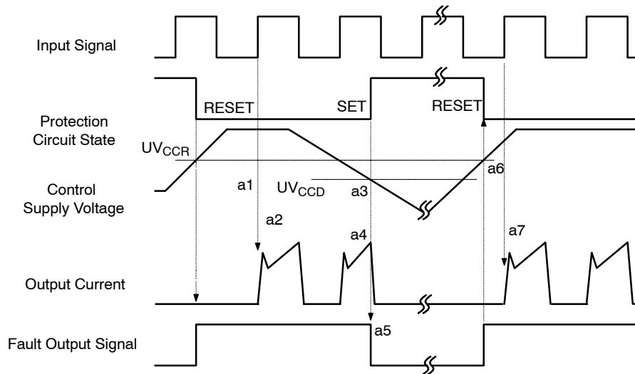
a1: 控制电源电压上升: 当电压上升到  $UV_{CCR}$  后, 等到下一个开通信号时, 对应的电路才开始动作。
