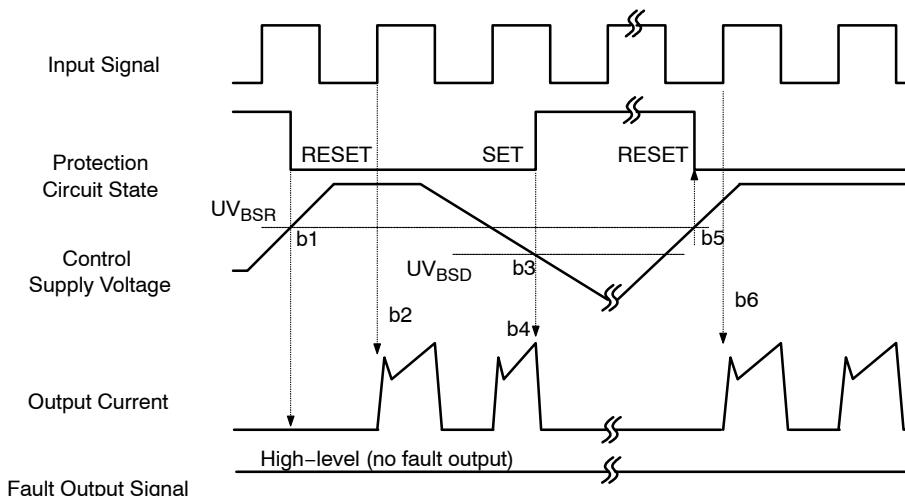
b1: 控制电源电压上升: 当电压上升到  $UV_{BSR}$  后, 等到下一个输入信号时, 对应的电路才开始动作。
