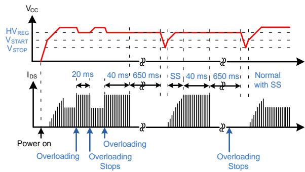
图 22. 过载保护 (OLP) 波形
