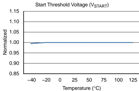
图 7. 启动阈值电压与温度的关系
