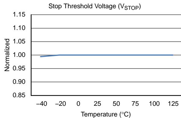
图 8. 停止阈值电压与温度的关系
