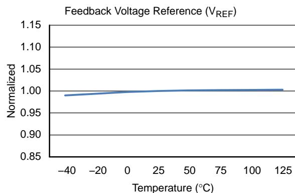
图 12. 反馈电压参考与温度的关系
