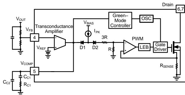
图 19. 脉宽调制 (PWM) 电路
