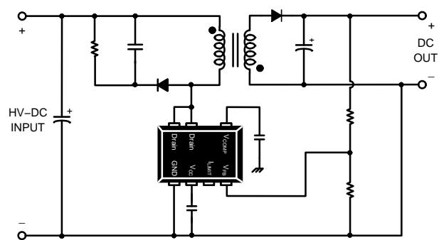
图 2. 非隔离反激式转换器应用
