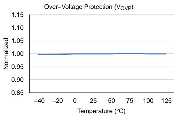
图 16. 过压保护与温度的关系
