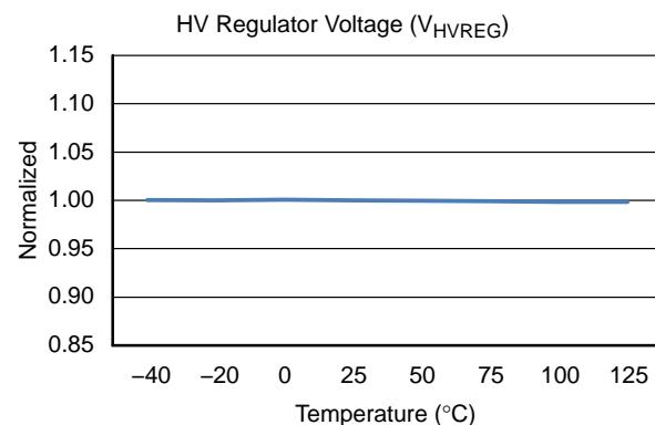
图 6. 高压调节器电压与温度的关系
