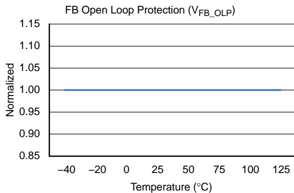
图 14. FB 开路保护电压与温度的关系
