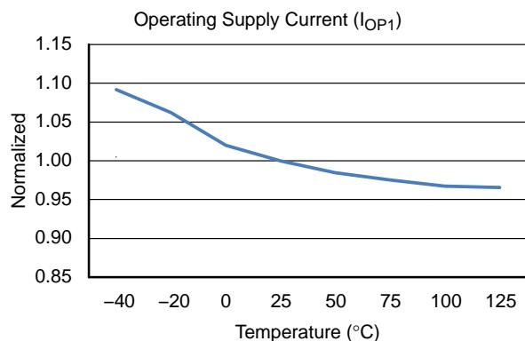
图 11. 工作电源电流 1 与温度的关系
