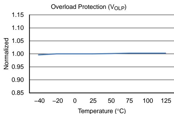
图 15. 过载保护与温度的关系
