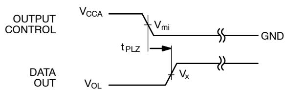
图 11. 3态输出高电平使能时间 (说明 18)
