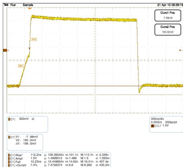
图 5. 波形C: 600 pF, Total RPU: 2.2 kΩ
