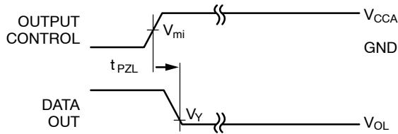
图 10. 3态输出低电平使能时间 (说明 18)
