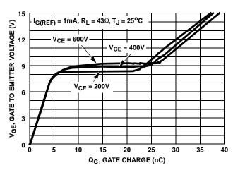
FIGURE 14. GATE CHARGE WAVEFORMS
