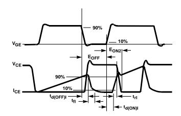
FIGURE 21. SWITCHING TEST WAVEFORMS
