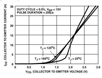
FIGURE 6. COLLECTOR TO EMITTER ON-STATE VOLTAGE
