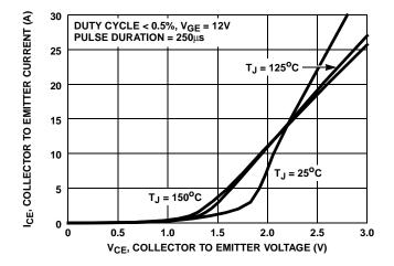
FIGURE 5. COLLECTOR TO EMITTER ON-STATE VOLTAGE
