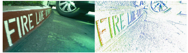
图 15. 捕获的彩色图像和相应的信号相位/距离 (近处物体偏红, 远处物体偏蓝)。
