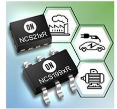
NCS214R 和 NCV214R (AEC-Q100 认证) 是电压输出电流感应放大器，可以在 -0.3 V 至 26 V 的共模电压下测量分路电压，而无论电源电压如何。在固定增益为 100V/V 的情况下，该零漂移结构的低偏移量使得电流感应分路中的最大下降低至 10 mV (满度量)。此类器件可基于一个 +2.2 V 至 +26 V 电源运行，获取最大 80  $\mu$ A 的供应电流。采用 SC70-6 和 UQFN10 封装。其他可用增益选项有：NCS213R (50 V/V)，NCS210R (200 V/V)，NCS211R (500 V/V)
