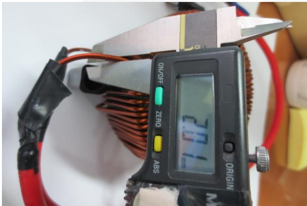
图 6. 铜线宽度 (2.01 mm)
