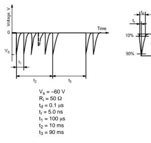
Figure 13. ISO 7637–3, Pulse 3a Waveform
