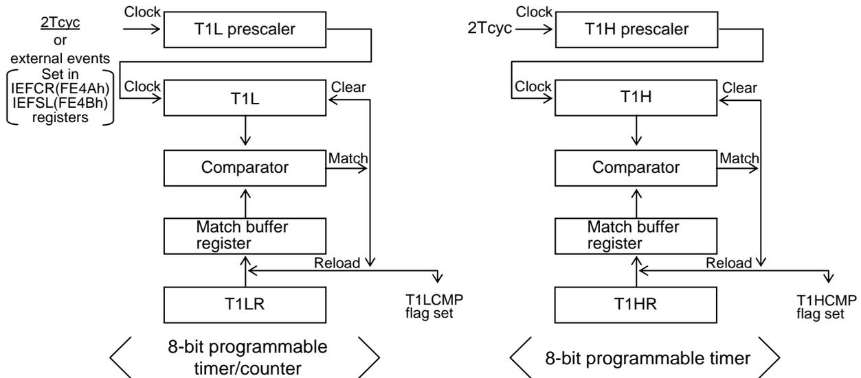
**Figure 3.4.1 Mode 0 (T1LONG = 0) Block Diagram**
