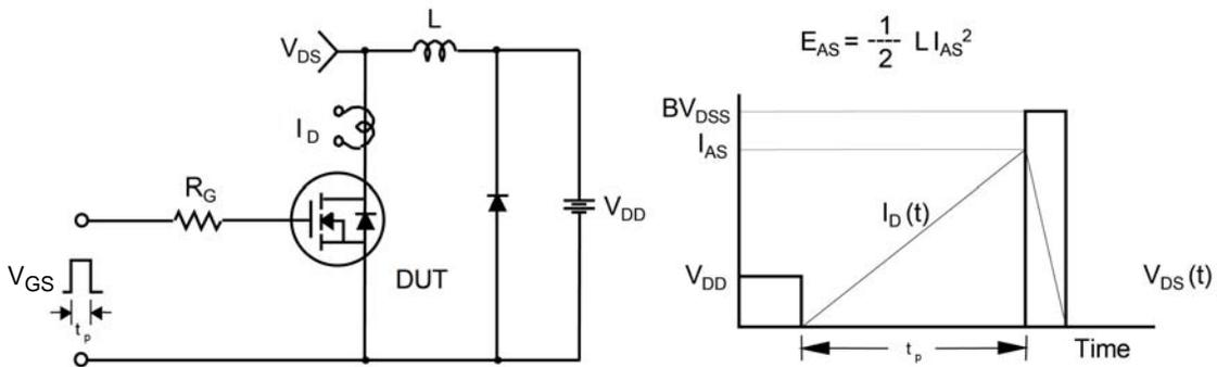
图 16. 非矩形感性开关测试电路与波形
