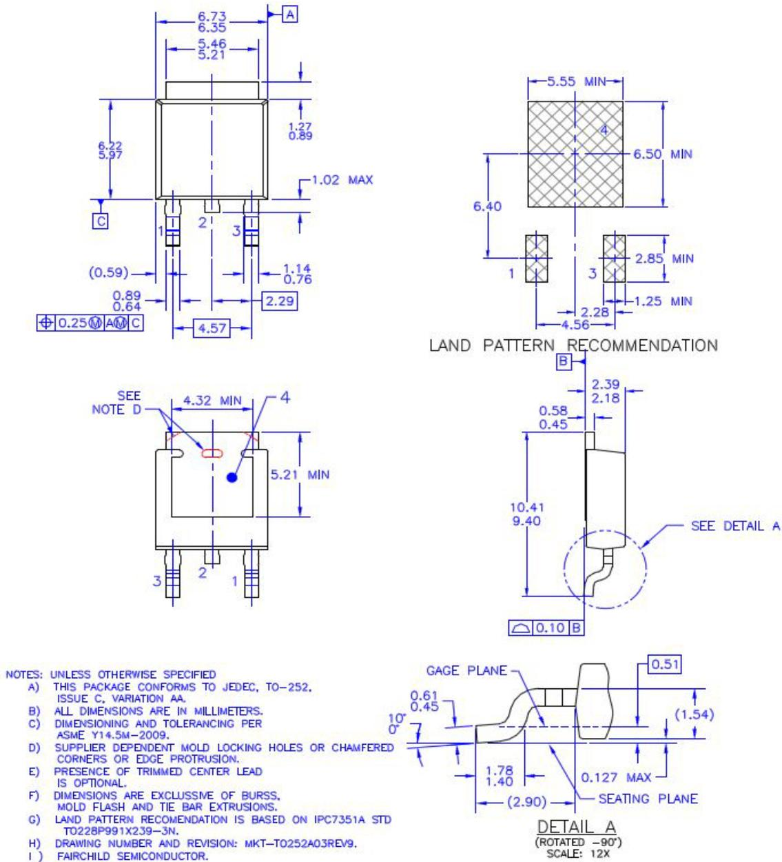
图 18. TO252 (D-PAK), 模塑, 3 引脚, 选项 AA&AB
