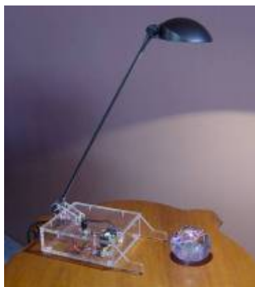
带PFC的NCP1014 LED驱动器 4 LED Cree MC-E
