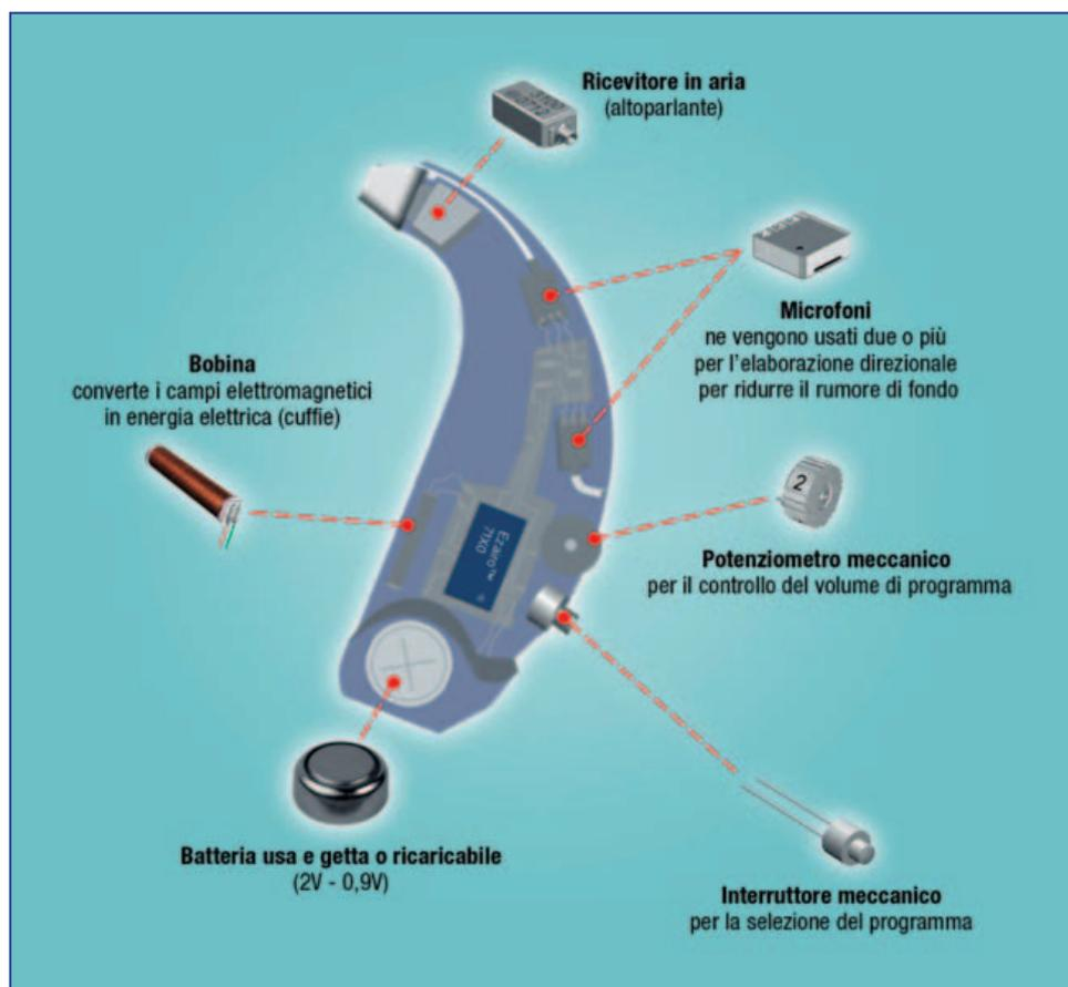
**Fig. 3 – La tipica forma a guscio dell'apparecchio acustico impone stretti vincoli di spazio**
