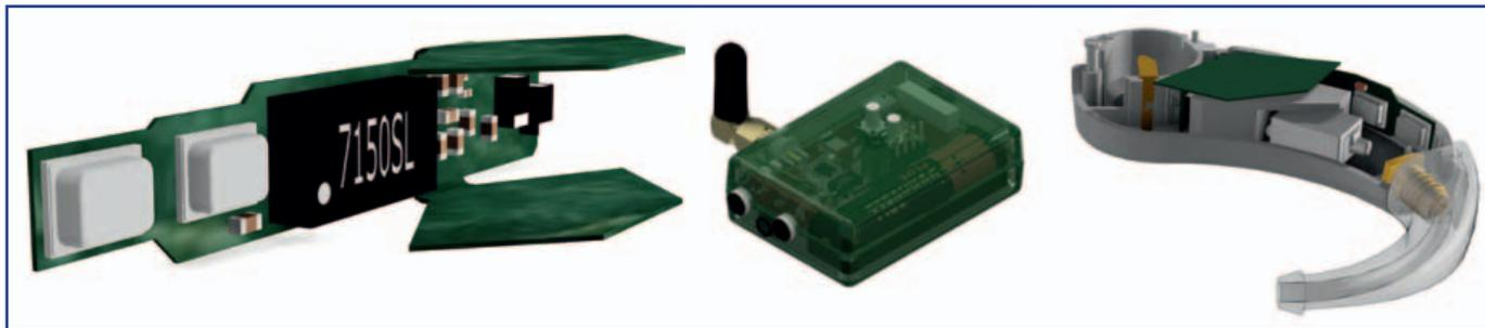
**Fig. 4 – Il progetto di riferimento con l'alloggiamento BTE, il circuito flessibile e l'antenna per accelerare lo sviluppo del progetto**
