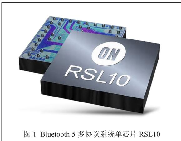
图 1 Bluetooth 5 多协议系统单芯片 RSL10
