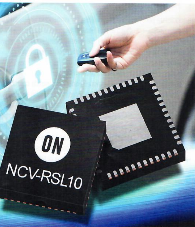
Fig. 4 – Il package QFN di NCV-RSL10 prevede terminali saldabili anche sui bordi del chip (wetttable flank) per consentire l'ispezione visiva automatica successivamente all'assemblaggio
